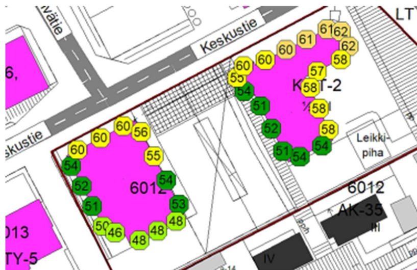
Kuva: Julkisivuihin kohdistuvat suurimmat päiväajan keskiäänitasot.
